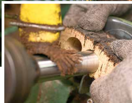
Des cylindres sont prélevés dans les bandes d'écorce. Les chutes (70% environ) sont réduites en granulés, utilisés pour des bouchons microagglomérés.
